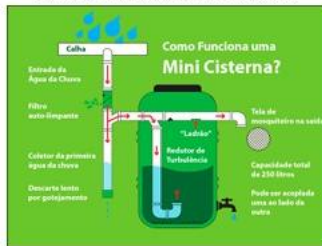
Figura 136 - Sistema para armazenamento de água da chuva.
