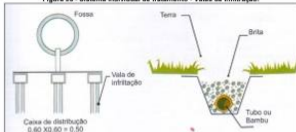
Figura 98 - Sistema individual de tratamento - Valas de Infiltração.
