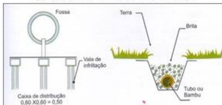
Figura 53 – Sistema de tratamento individual – Valas de Infiltração.
