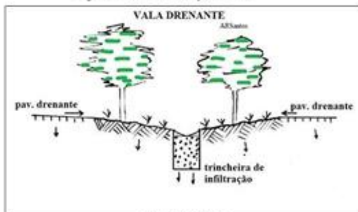
Figura 140 - Vala de infiltração drenante.
